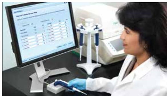
Дополнительный RFID-сканер работает со всеми пипетками Rainin с RFID-метками и поддерживает функцию проверки калибровки пипеток Direct Pipette-Scan™ с помощью ПО METTLER TOLEDO LabX™.
